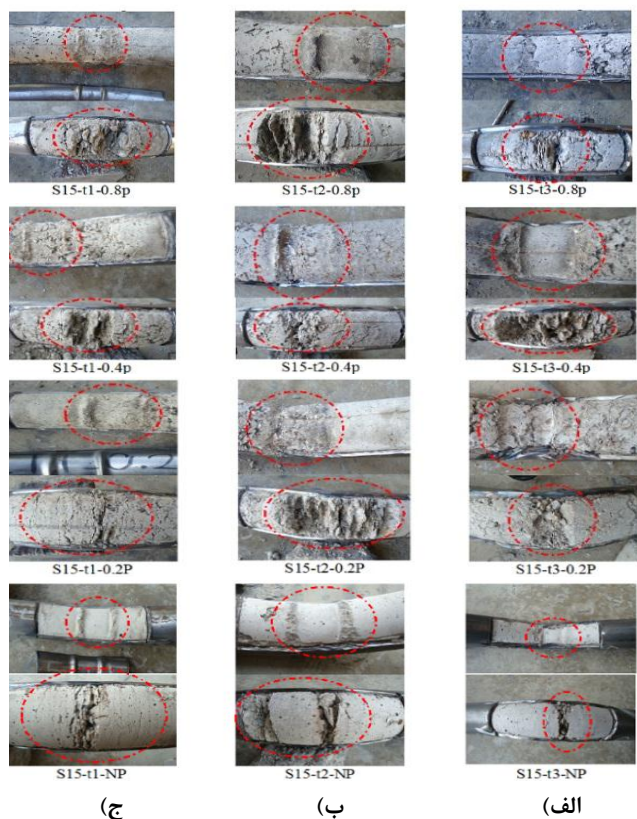
شکل ۵- مود شکست کلیه نمونه‌ها (الف) t=1\text{ mm} ، (ب) t=2\text{ mm} ، (ج) t=3\text{ mm}
