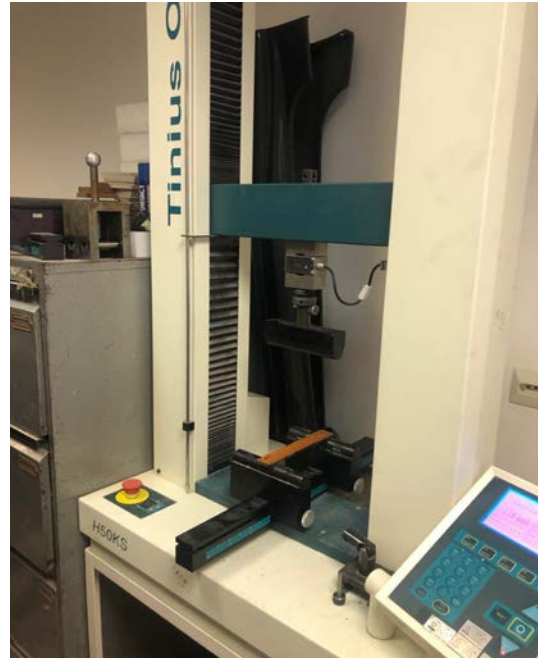
شکل ۳ دستگاه اندازه‌گیری مقاومت خمشی
