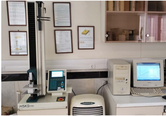
شکل ۳ دستگاه اندازه‌گیری مقاومت فشاری مورد استفاده در این پژوهش
