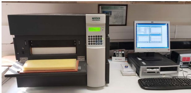
شکل ۴ دستگاه اندازه‌گیری ضریب هدایت حرارتی (به روش جریان حرارت‌سنج) مورد استفاده در این پژوهش
