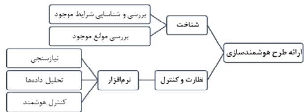
شکل ۳ پیکربندی بخش نظارت سامانه مدیریت هوشمند
