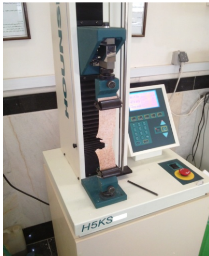
شکل ۳ آزمون مقاومت کششی نمونه‌های آجر انعطاف پذیر ساخته شده در آزمایشگاه
