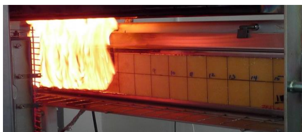
شکل ۳- تصویری از آزمون پیشروی سطحی شعله طبق استانداردهای ISO و IMO (آزمایشگاه آتش مرکز تحقیقات راه، مسکن و شهرسازی)
