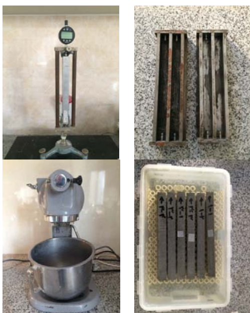
شکل ۲- وسایل و تجهیزات لازم به منظور انجام آزمایش انبساط منشور ملات طبق استاندارد ASTM C1260
