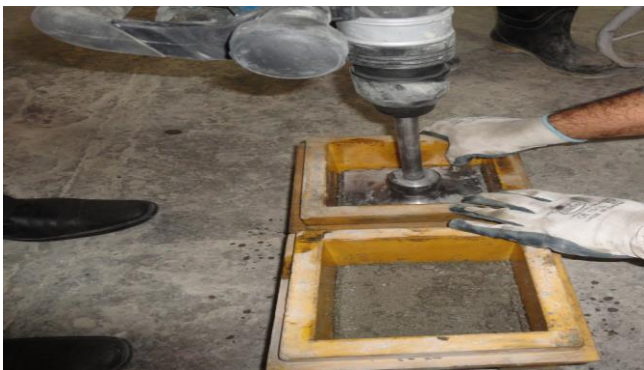
شکل ۱- تراکم آزمونه‌های بتن غلتکی توسط چکش لرزه‌ای
